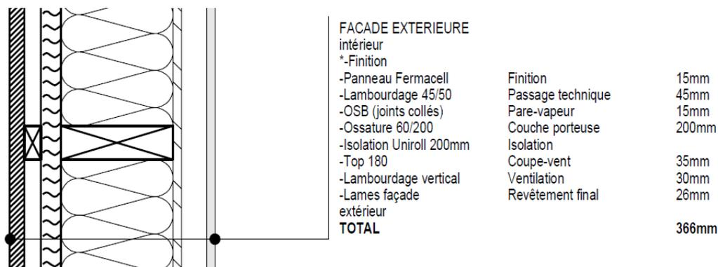
Le but de ces couches est d'empêcher la vapeur d'eau de condenser à l'intérieur de la couche porteuse, ce qui mènerait au pourrissement de la structure.
